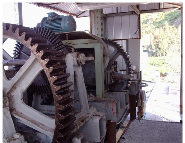
Rehabilitación de carro (motor, pintura, engranajes y protección)
