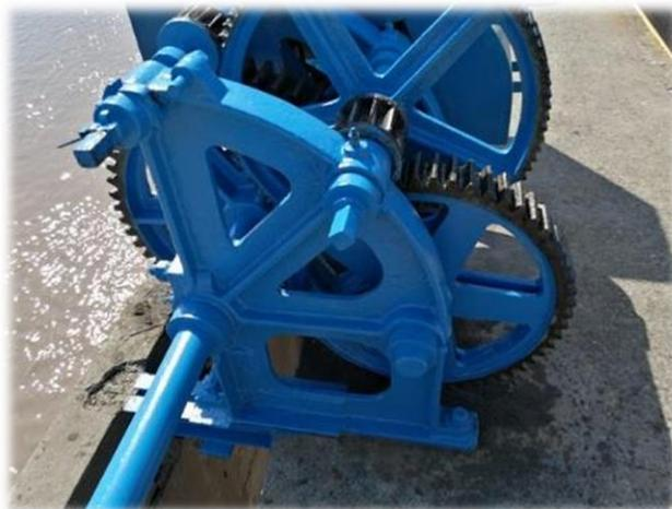
Reparación soporte motor compuerta canal Huidobro.
