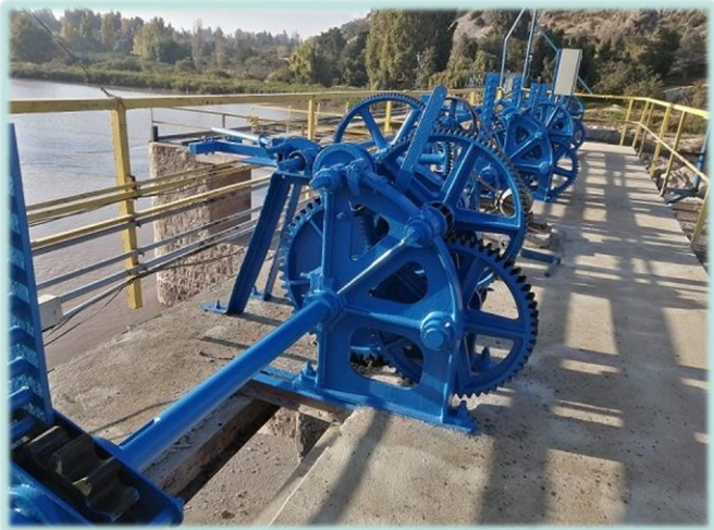
Mantenimiento engranajes compuertas altas.
