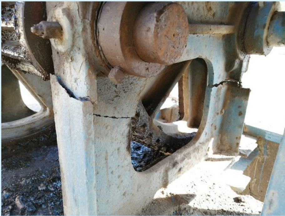
Reparación soporte engranajes compuerta Canal Huidobro.
