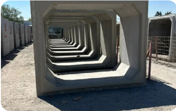
Solución: Cajón Prefabricado H.A. 1,5 m x 0,8 m
